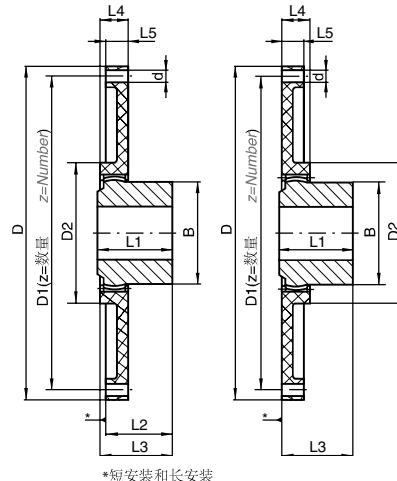
**SAE 法兰和轴套的尺寸****Flange and hub dimensions SAE**
