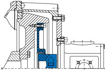
典型应用举例：DENTEX® FL联轴器安装在柴油发动机和液压泵之间。
